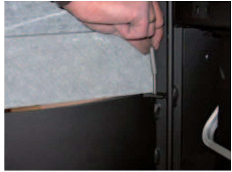
38. När stenen sitter på plats ska skruvarna skruvas åt försiktigt så att stenen inte ger vika.
