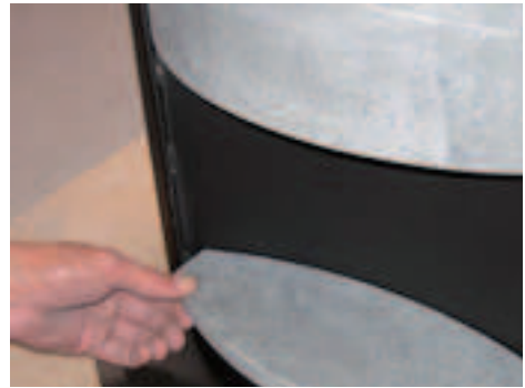
39. Golvstenen ska sättas in på snedden i askluckan och vridas på plats.
